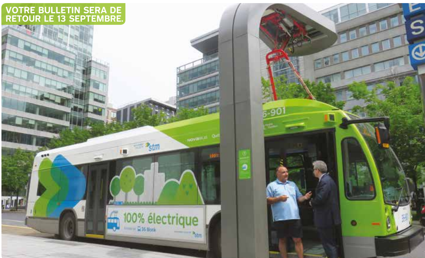
Le chauffeur Renaldo Scopelleti et Luc Tremblay discutent du trajet de la ligne 36 tandis que le bus 100 % électrique 36-901 recharge ses batteries au pantographe du square Victoria.
